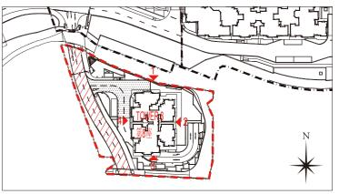
INTERNAL DRIVEWAY / E.V.A. 內部車道 / 緊急車輛通道
